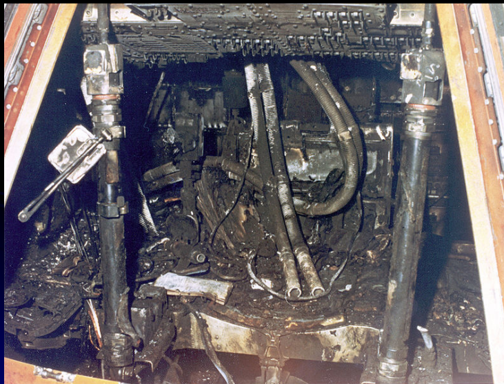
Apollo-Kapsel nach dem Feuersausbruch
