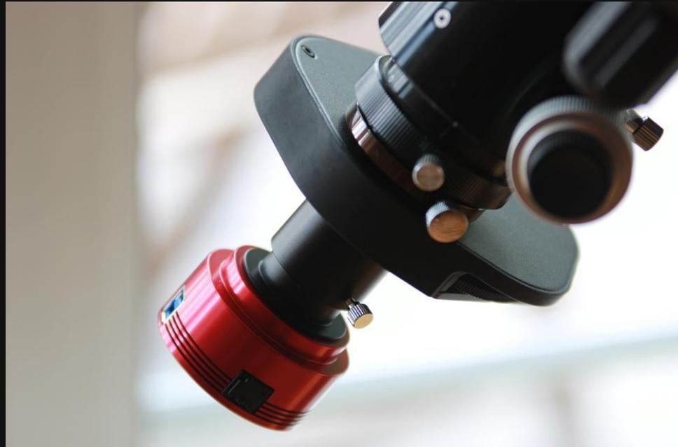
A.S.I. 178MM USB3.0-Kamera mit Filterrada an einem Crayford-Auszug
