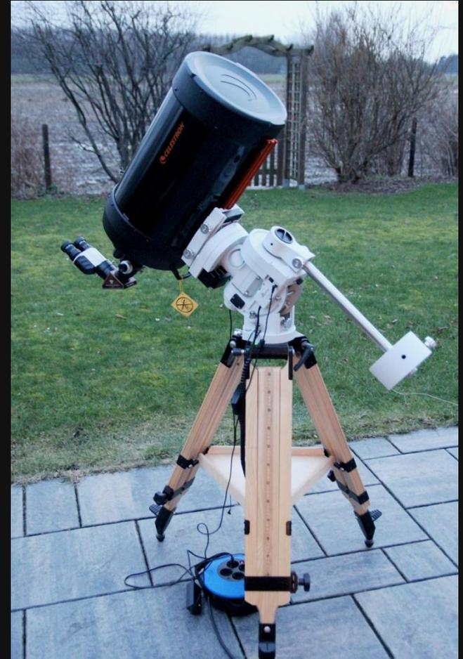
Schmidt-Cassegrain-Teleskop C11 auf CEM60-Montierung von iOptron
