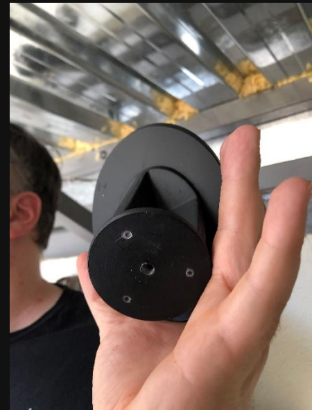
Zu einfacher Aufbau der Fangspiegelhalterung
