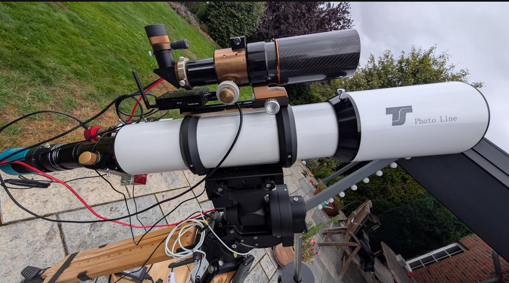
Verbindung der StellaVita mit dem Teleskop-Equipment (Montierung, Guiding-Kamera, Hauptkamera, Motor-Fokussierer)
