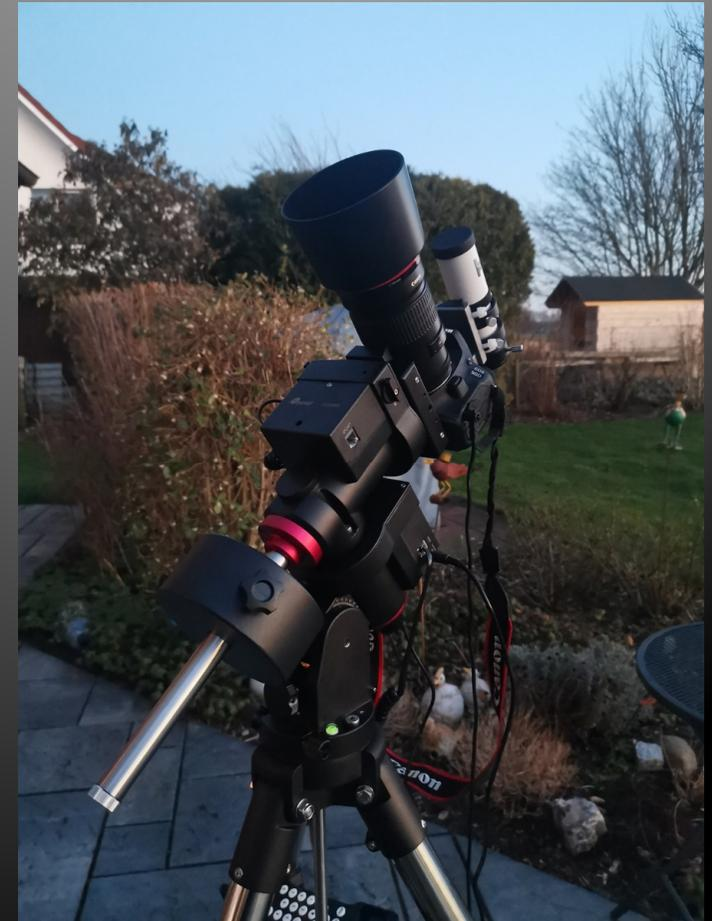
GEM28-Montierung mit Canon-Kamera und Leitrohr
