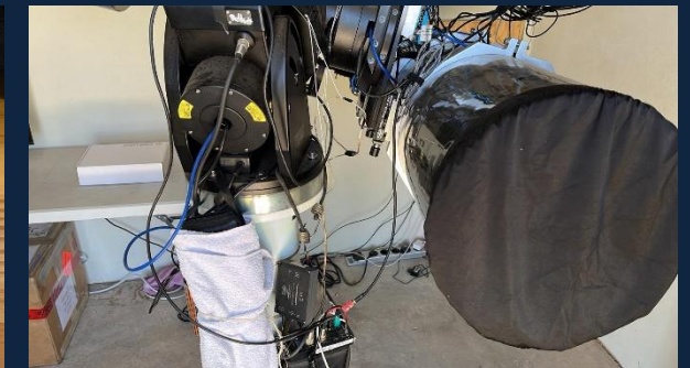
Abgeklebte Beleuchtung und umwickeltes Handsteuergerät
