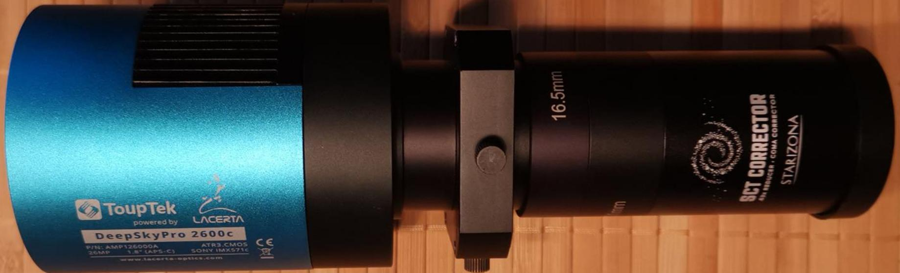
Imaging Train bei Einsatz eines Reducer/Flattners an einem C11-Teleskop
