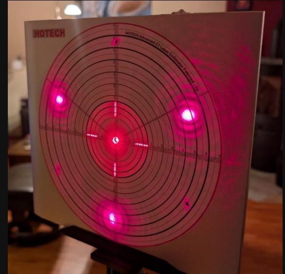
Optimale Kollimation bei f/10
