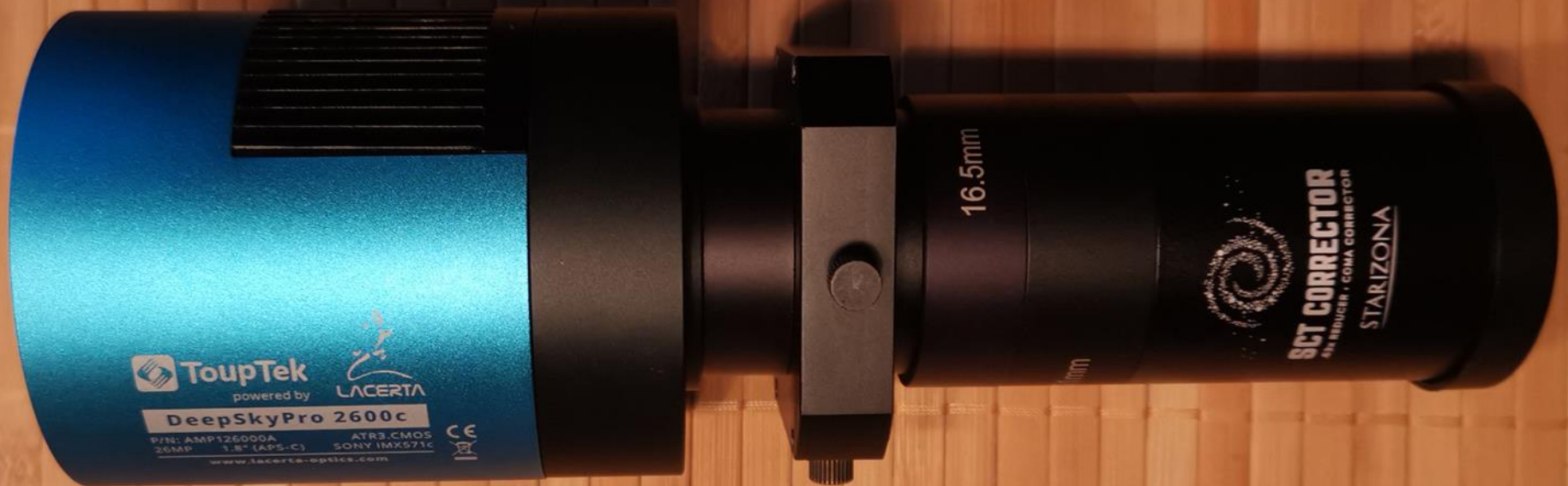
Imaging Train bei Einsatz eines Reducer/Flattners an einem C11-Teleskop
