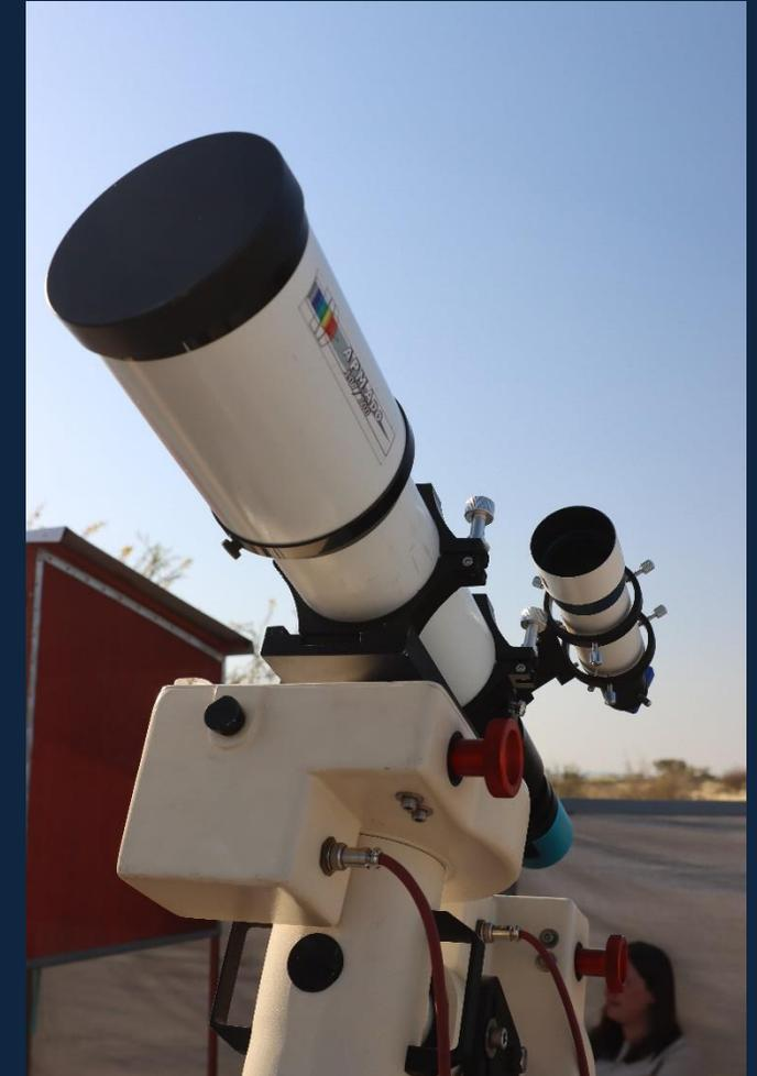
APM-Refraktor auf stabiler Fornax-Montierung
