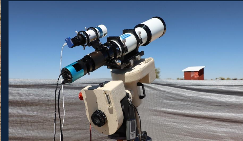
Eingesüdete Fornax 51-Montierung mit aufgesatteltem Refraktor APM APO 107/700 mm und eigenem Autoguider M-GENV3 sowie Astrokamera Lacerta DeepSkyPro2600c
