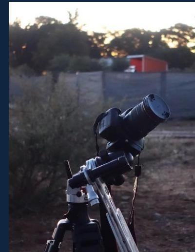
Eingesüdete Vixen GP-DX-Montierung mit aufgesatteltem Refraktor TS Triplet 90mm-f/6,6-APO bzw. Sigma 70-200 mm F2,8 EX DG OS HSM-Objektiv
