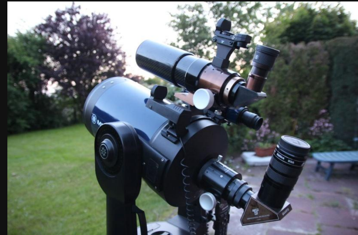
8" SC-Teleskop mit azimuthaler Gabelmontierung und aufgesatteltem ED70-Refraktor
