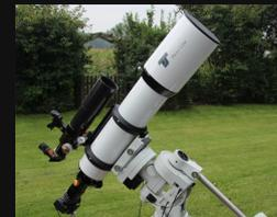
Fotografie mit dem APO130-Refraktor auf CEM60-Montierung
