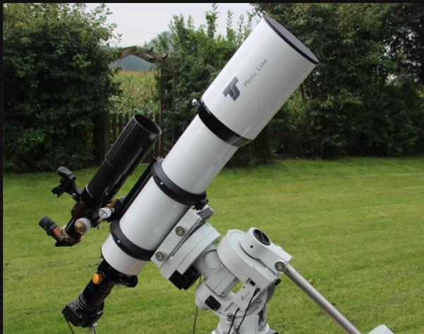
Parallaktische Montierung mit TS PHOTOLINE 130 mm-f/7-Triplett-APO und ED70-Refraktor
