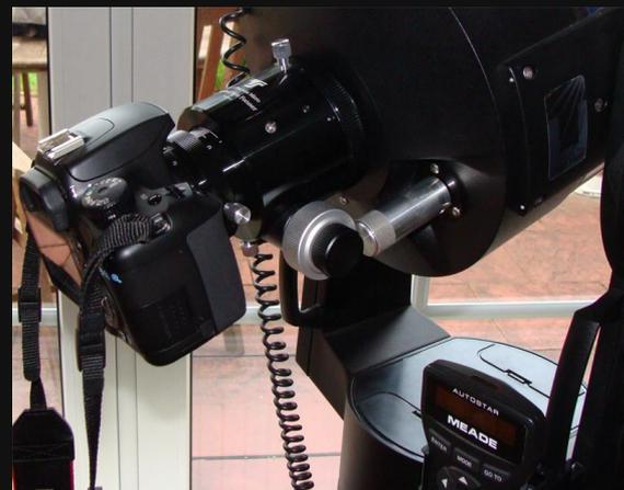
Azimutale Montierung mit 8" Schmidt-Cassegrain-Teleskop LX90 und Fokalfotografie mittels Canon 1000D-Kamera
