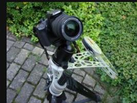
Fotografie mit Weitwinkel-Objektiv auf AstroTrac-Reisemontierung
