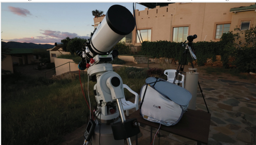
Abb. 8: Betrieb des eigenen Equipments – AstroTrac mit Canon 90Da und Esprit 100ED mit Lacerta DSP2600c.
