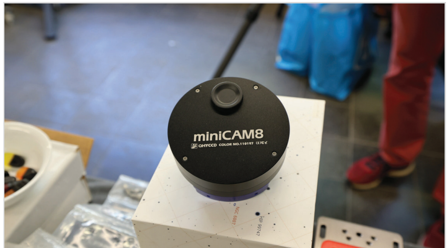
Abb. 6: miniCAM8 mit IMX585-Chip von QHYCCD.
