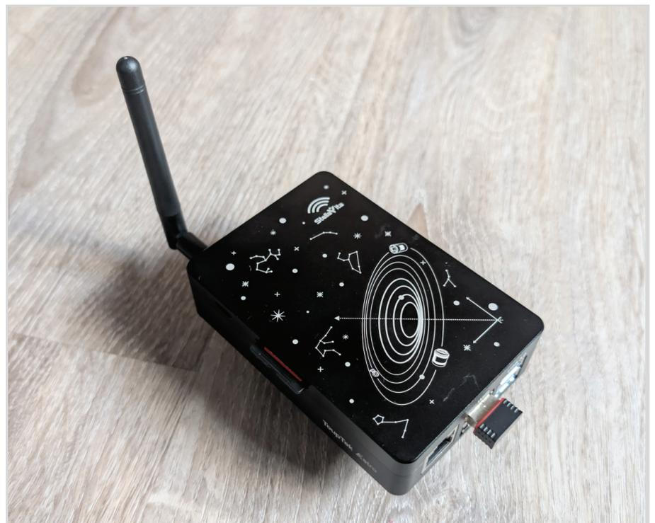
Abb. 1: StellaVita von ToupTek mit SD-Speicherkartenslot und USB-Anschlüssen.
