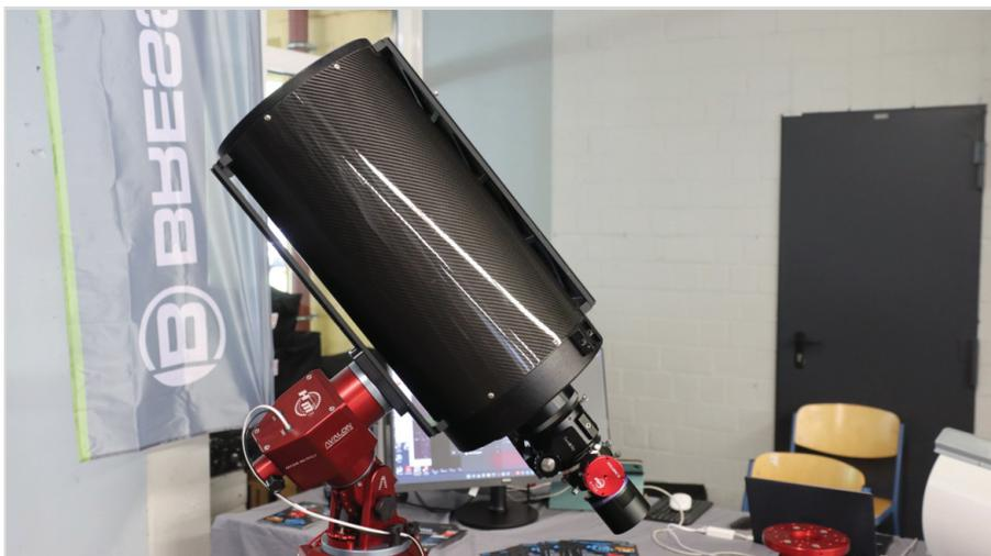
Abb. 7: Auch Avalon bietet inzwischen eine Harmonic-Drive-Montierung an.
