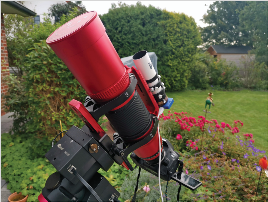
Abb. 4: William Optics RedCat71 mit aufgeschraubter Taukappe, Guiding-Teleskop und DSLR-Kamera
