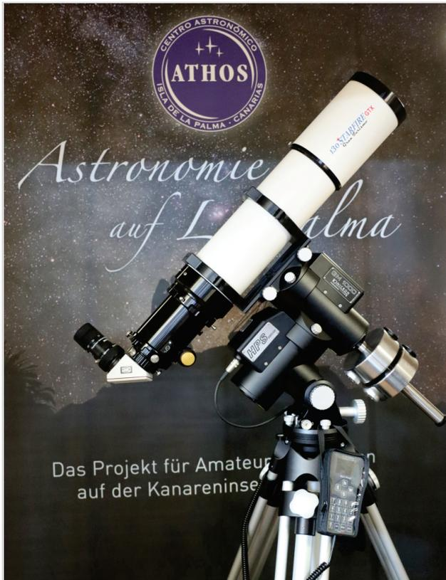
Abb. 2: Apochromatischer Refraktor Astro-Physics 175 EDFS auf 10Micron-Montierung GM1000.
