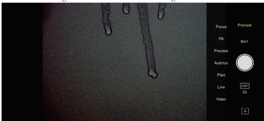
Abb. 7: Ölaustritt im Bereich der Sensorkammer [4].
