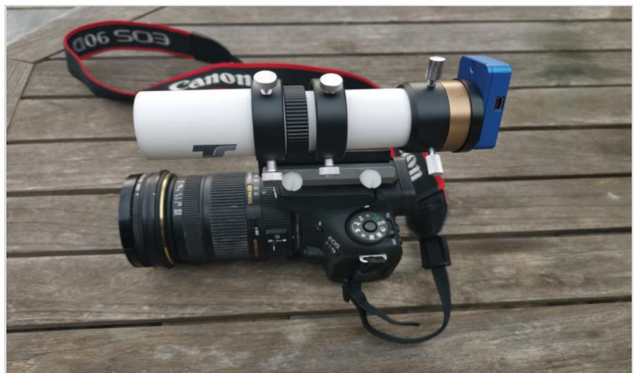
Abb. 7: Mini-Leitrohr mit Sucherhalter für Blitzerschuh an der Canon 90Da.
