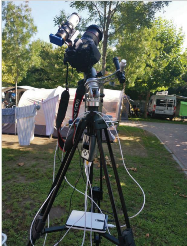
**Abb. 4:** AstroTrac mit Canon 90Da, Mini-Leitrohr, Polsucher, M-GEN V3 und Powerbank.
