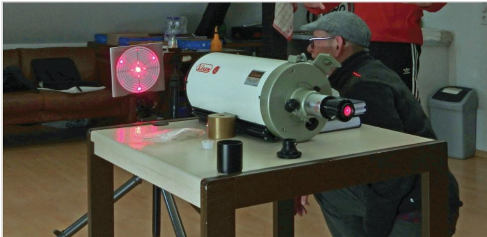
Abb. 16: Exakte Kollimation des VC200L und Überprüfung der Laser durch Ernst-Jürgen Stracke [9].
