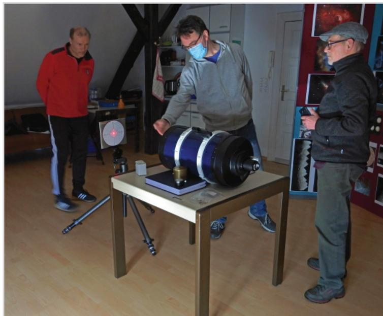
Abb. 17: Ausrichtung des 10<sup>6</sup> Meade SC-Teleskops an dem Hotech-Kollimator mit vereinten Kräften [9].
