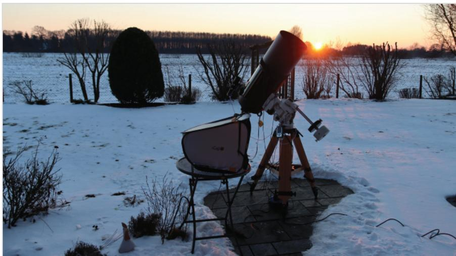
**Abb. 1:** C11-Teleskop mit HyperStar-Korrektor und Taukappe für Aufnahmesession im Winter vorbereitet.
