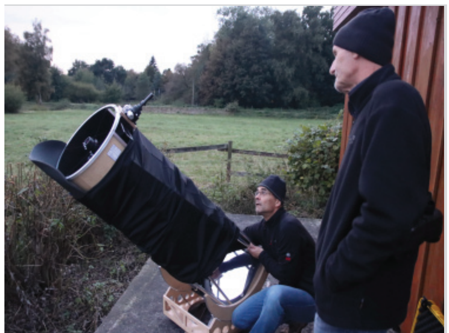
Abb. 2: Justierung des Selbstbau-Dobson von Kai Wicker vor Eintreffen der Dunkelheit.
