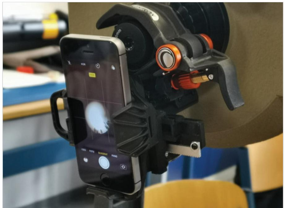
Abb. 4: Smartphone-Halterung NEXYZ an einem Celestron C8.
