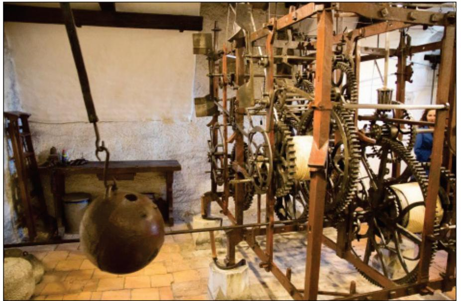
Abb. 12: Zahnradgetriebe der Zytglogge mit Pendelantrieb.
