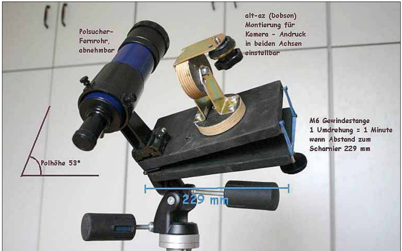
Abb 2: Beispiel einer selbstgebauten Barndoor-Montierung [1]
