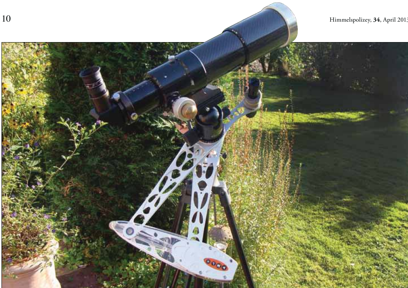
Abb 8: AstroTrac mit ED70-Refraktor zur Sonnenbeobachtung
