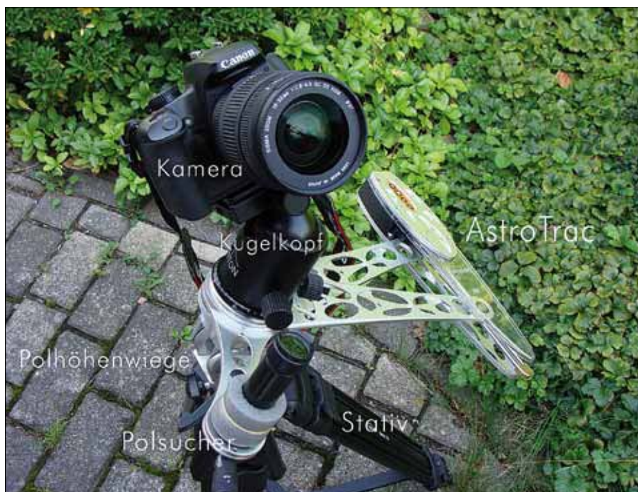
Abb. 3: AstroTrac TT320X-AG mit Polsucher, Polhöhenwiege, Kugelkopf und Kamera
