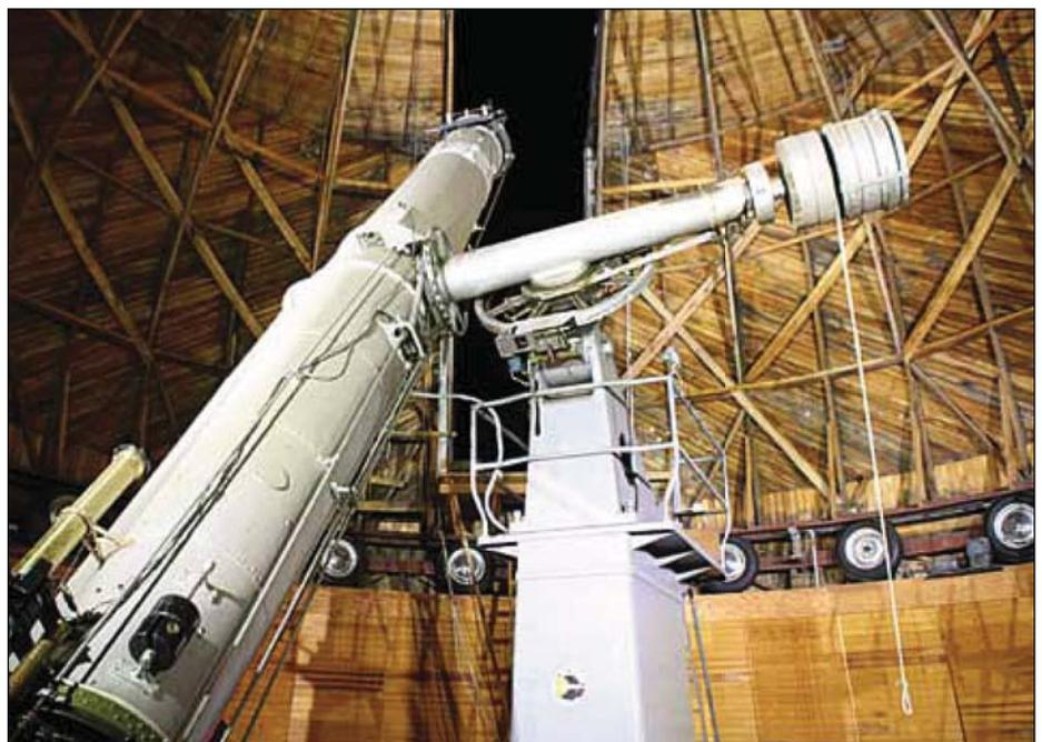
Abb. 2: 61-Zentimeter-Refraktor im Lowell-Observatorium
