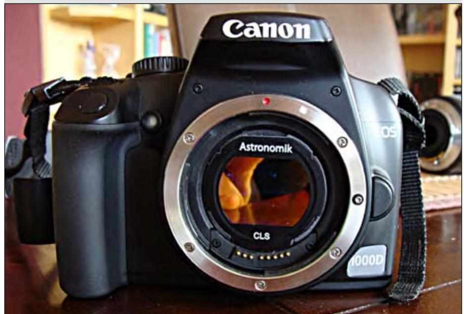
Abb 5.: Umgebaute DSLR-Kamera 1000D mit Astronomik CLS-Filter
