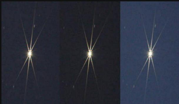
Strahlengang eines hellen Sterns durch eine Bahtinov-Maske (Quelle: Wikipedia)
