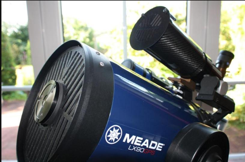
Einsatz der Bahtinov-Maske an SC-Teleskop und Refraktor
