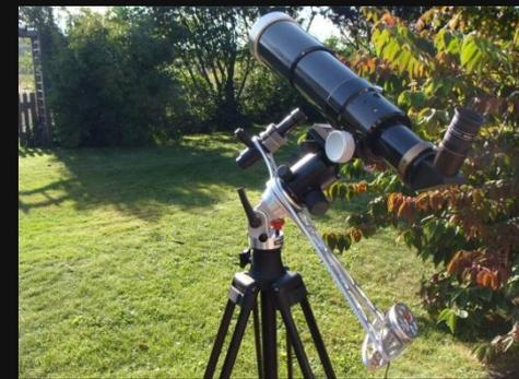
ED70-Refraktor mit parallaktischer Montierung mittels AstroTrac
