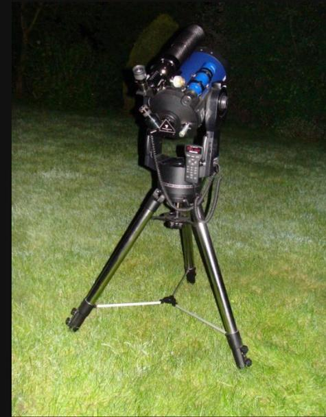
Schmidt-Cassegrain-Spiegelteleskop mit azimutaler Montierung
