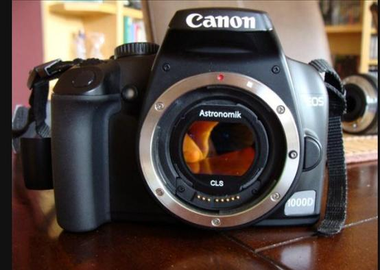
Canon 1000D(a) DSLR-Kamera mit Astronomik CLS-Clip ohne IR-Sperrfilter
