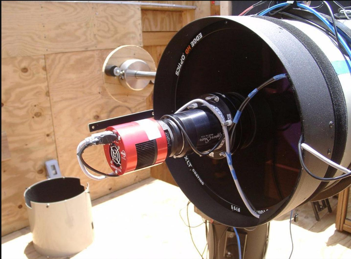
Optimale Kabelführung am HyperStar ohne Spikes an den Sternen zu erhalten
