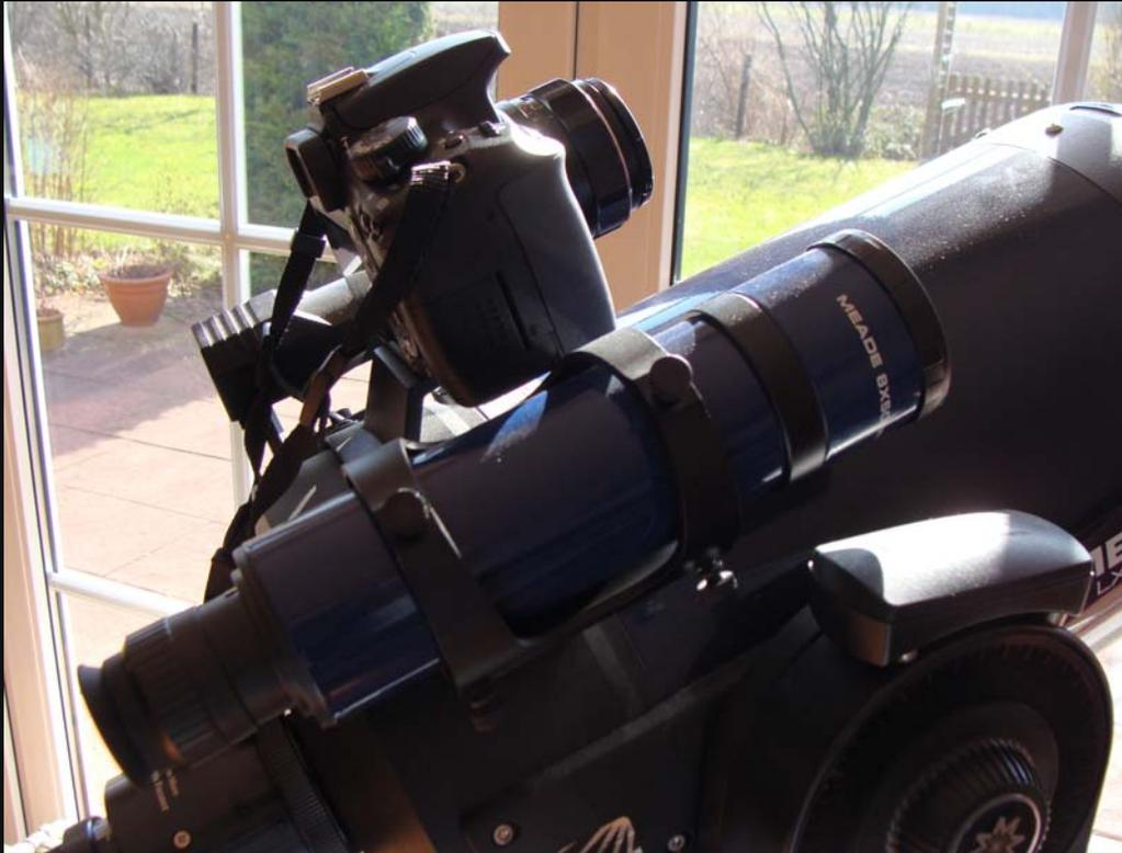
Bei der Piggyback-Halterung wird die Kamera huckepack auf das Teleskop montiert:
