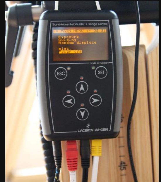
Autoguiding mit der M-GEN
