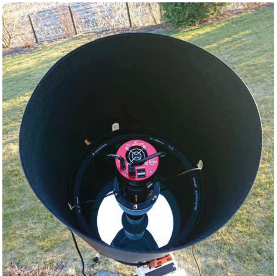
1 C11-HyperStar (280/2800 mm, Montierung: iOptron CEM60) mit Kamera ASI 183MCpro und Tauschutzkappe
