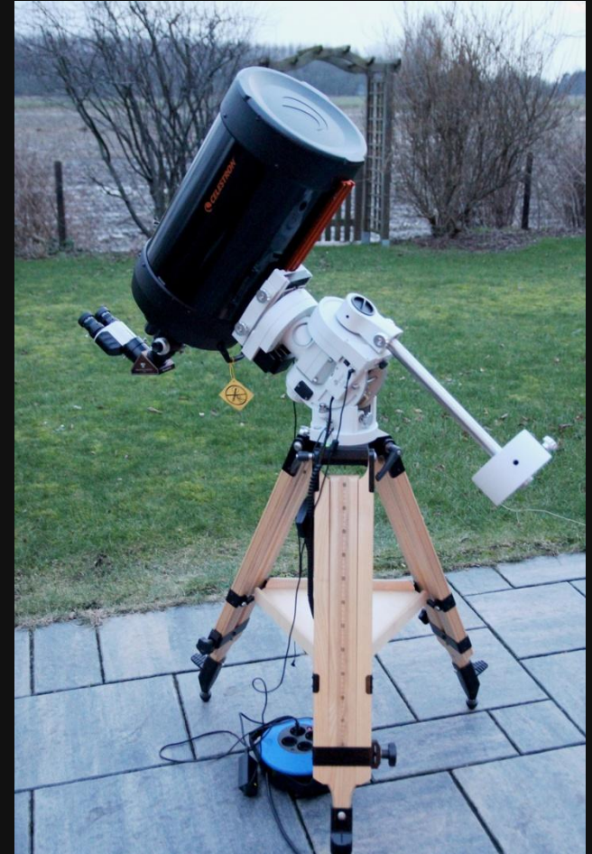
Schmidt-Cassegrain-Teleskop C11 auf CEM60-Montierung von iOptron
