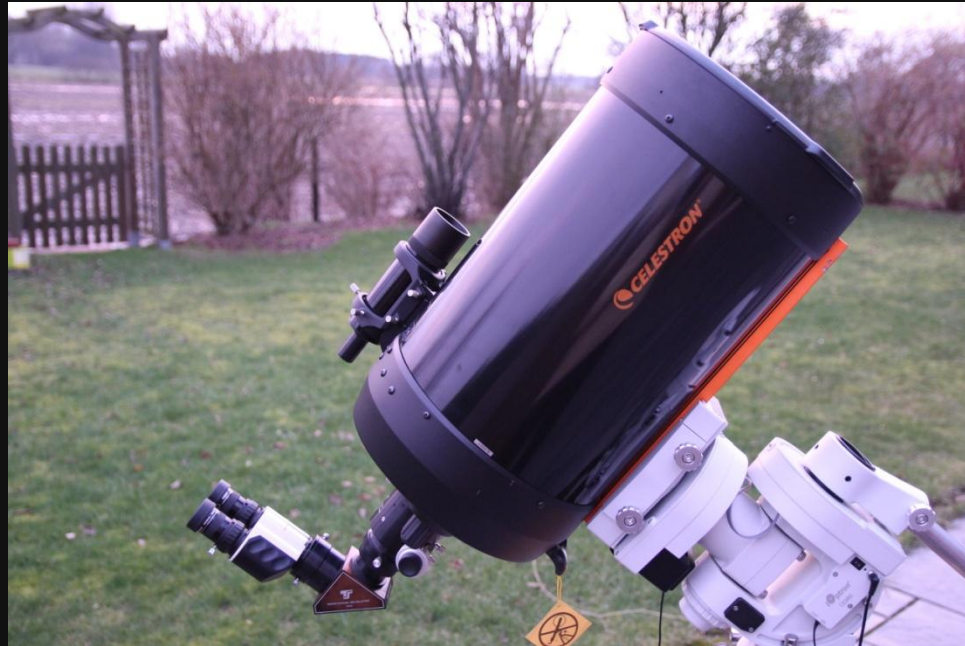
C11-Teleskop, Schmidt-Cassegrain mit 11" Öffnung und 2,8 m Brennweite
