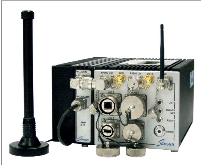
Bild 2: HiMoNN-Basis für Ad-hoc-Netze in Krisensituationen
