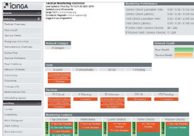
Bild 1: Spezielle Zustandsübersicht mit Hilfe von Icinga-Monitoring
