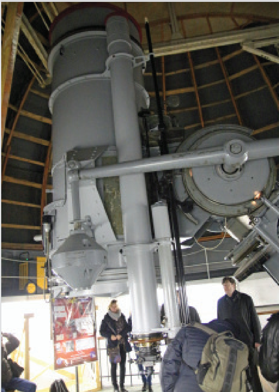
Abb. 4: Das 1m-Spiegelteleskop der Firma Carl Zeiss mit Erläuterungen von David Walker.
