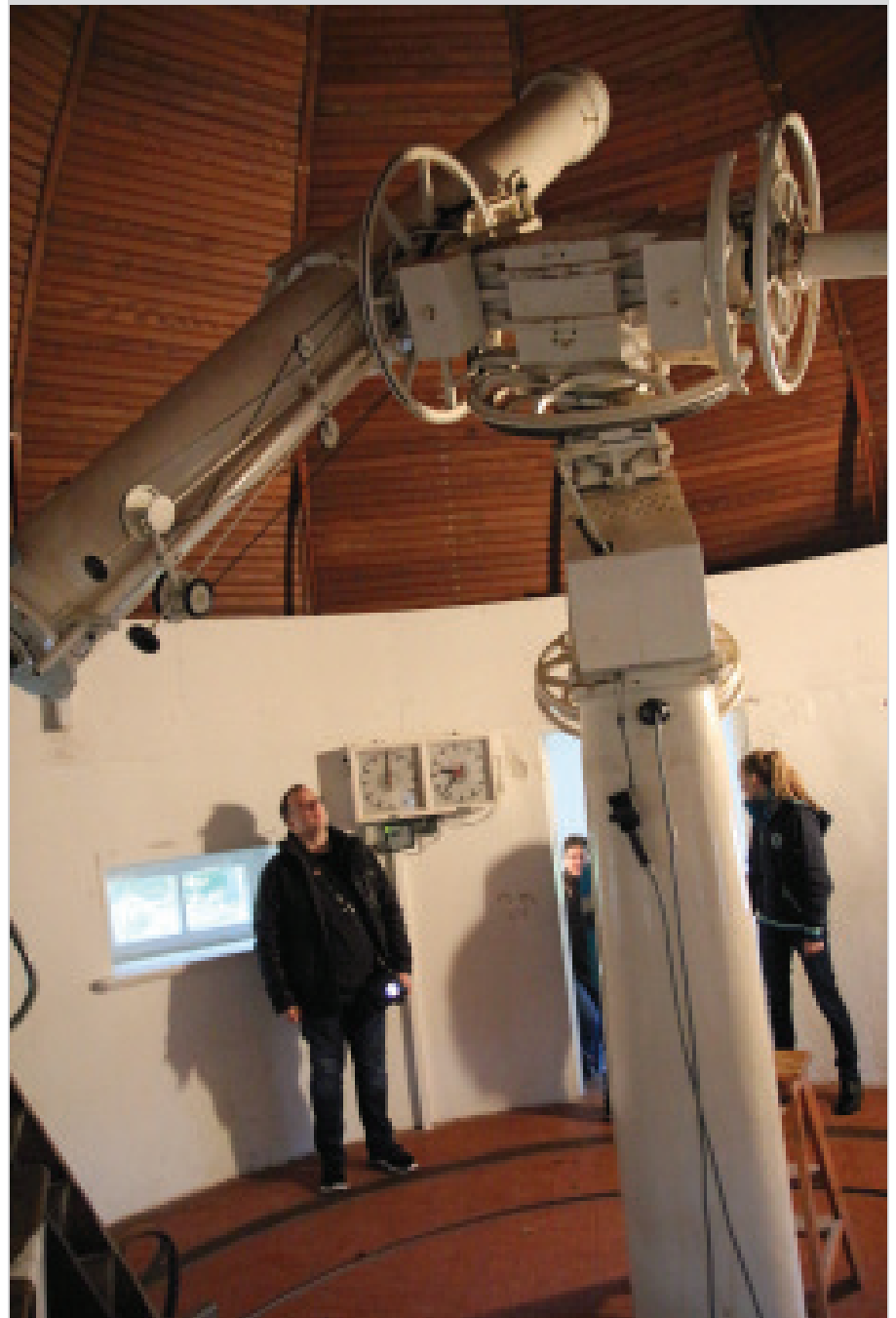
Abb. 6: Das älteste Teleskop der Sternwarte - der Äquatorial-Refraktor.
