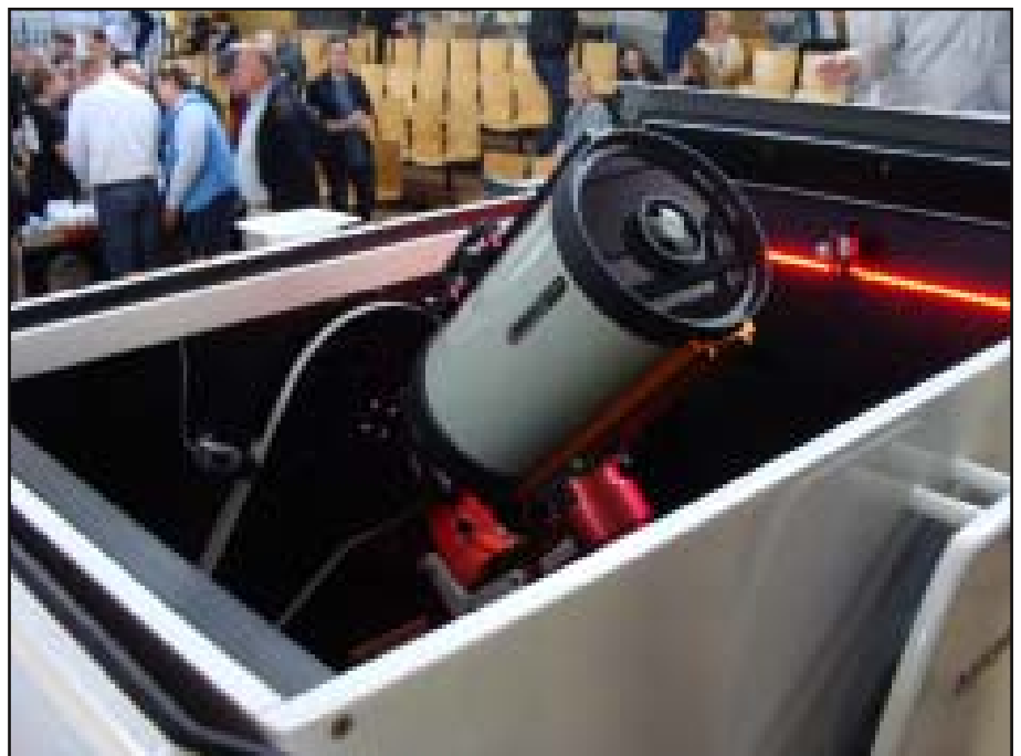
Abb. 3: Reisesternwarte als ferngesteuerte Außenstelle.
