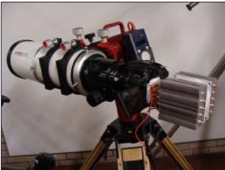
Abb. 5: Kühlung für DSLR-Kameras ohne Umbaumaßnahmen.
