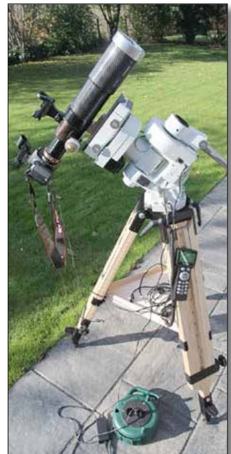
Abb. 3: ED70-Refraktor mit DSLR-Kamera Canon 1000D(a) auf iOptron CEM60.
