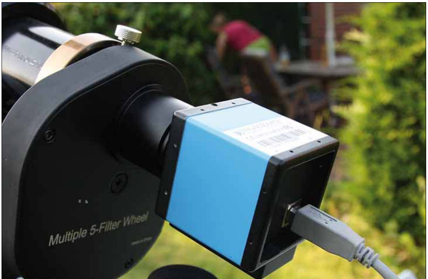
Abb. 3: CCD-Kamera von TIS mit Filterrad am ED70-Refraktor.
