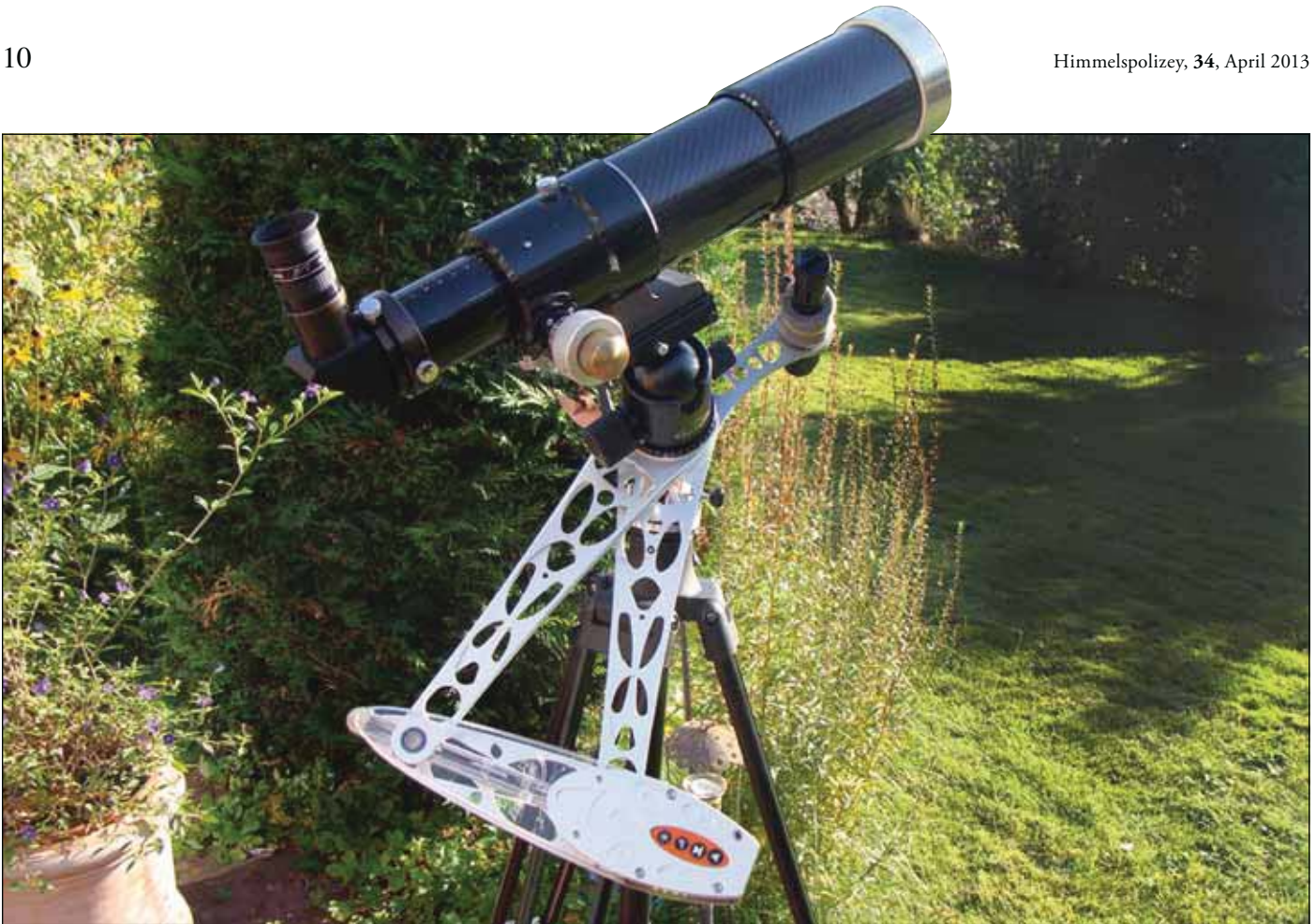
Abb 8: AstroTrac mit ED70-Refraktor zur Sonnenbeobachtung
