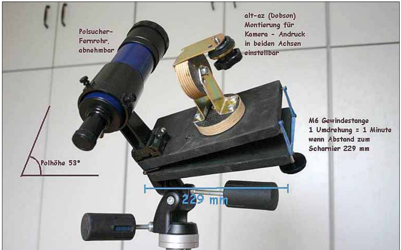
Abb 2: Beispiel einer selbstgebauten Barndoor-Montierung [1]
