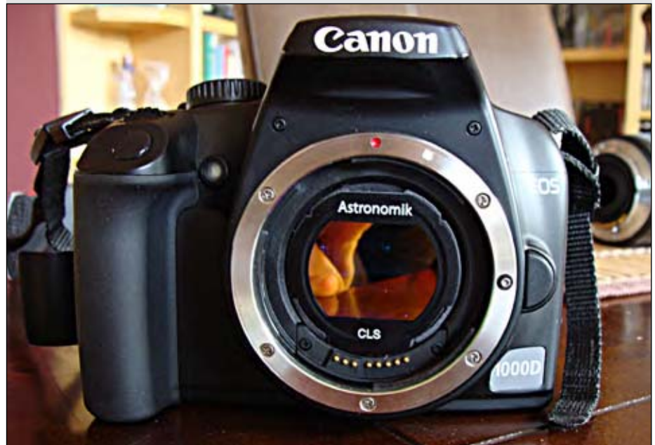
Abb 5.: Umgebaute DSLR-Kamera 1000D mit Astronomik CLS-Filter
