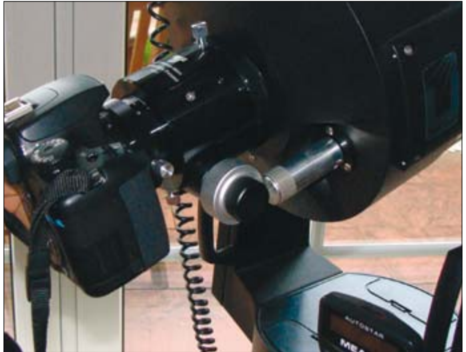
Abb. 7: Crayford-Auszug mit Canon-Kamera am SC-Gewinde des LX90-Teleskops.
