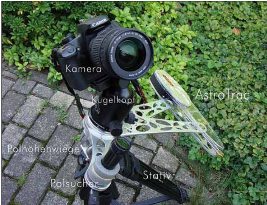
Abb. 3: AstroTrac TT320X-AG mit Polsucher, Polhöhenwäge, Kugelkopf und Kamera
