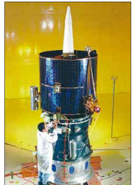
Abb. 4: Lunar Prospector im Reinraum bei der Fertigung (NASA, Public Domain) [4]
